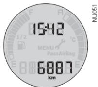
Ao ligar o veículo (chave de ignição em **MAR**), será visualizado os dados presentes antes do último desligamento. Se o display apresentava dados do hodômetro total antes do desligamento (Chave em **OFF**), então, este permanecerá no display.
